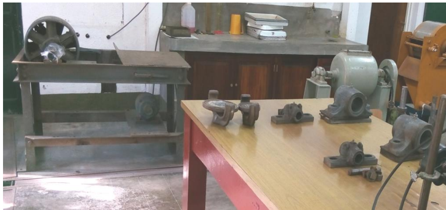
Foto N 17.- Despiece del molino de bolas para su limpieza.
