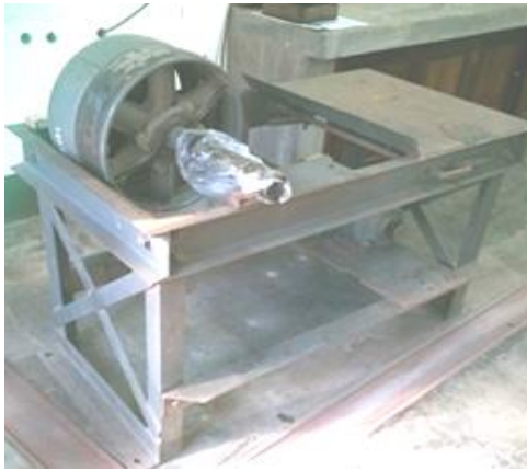
Foto N 16.- Desmontaje del molino de bolas para su limpieza.
