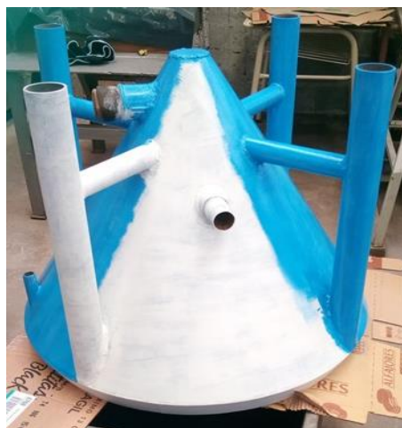
Foto N 13.- Limpieza y colocación de pintura especial y de color al alimentador realizado por el jefe de la Planta Piloto Sr. B. Cruz.
