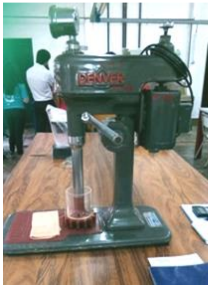
Foto N 15.- Colocación del motor reparado en la Celdas de flotación. Tareas de mantenimiento realizadas en forma conjunta
