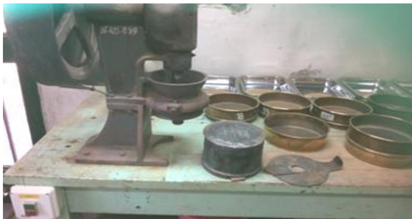
Foto N 11.- Reparación por soldadura del plato pulverizador de muestras
