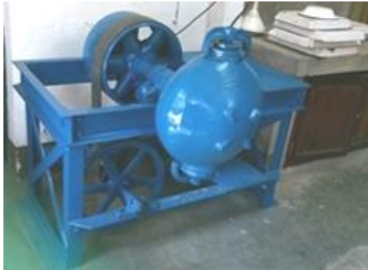
Foto N 19.- Estado del molino de bolas después de las tareas de mantenimiento realizado por los Técnicos L. Flores y B. Cruz, en el Laboratorio de Procesamiento de Minerales
