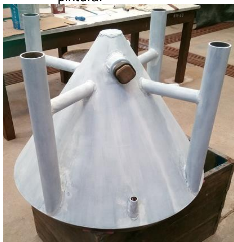
Foto N 13.- Limpieza y colocación de pintura especial y de color al alimentador realizado por el jefe de la Planta Piloto Sr. B. Cruz.
